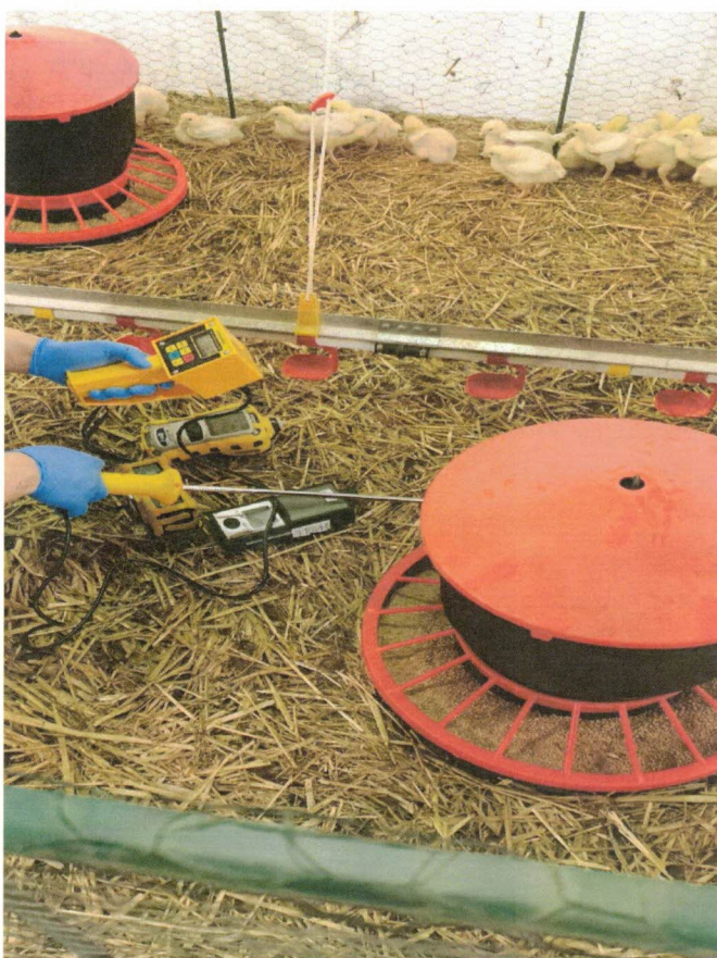
Fot. 2. Badanie stężenia gazów oraz parametrów ściółki
